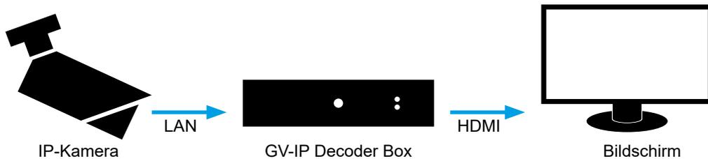
Das Livebild einer Kamera wird über HDMI übertragen. Insgesamt können bis zu 64 Kameras entweder direkt oder über ein GV-System (GV-NVR / GV-VMS) in der Decoder Box angelegt werden. Die Umschaltung und Bedienung ist mit der mitgelieferten Fernbedienung möglich.
